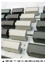
▲東東工場の暴露試験風景（南面35°傾斜）
